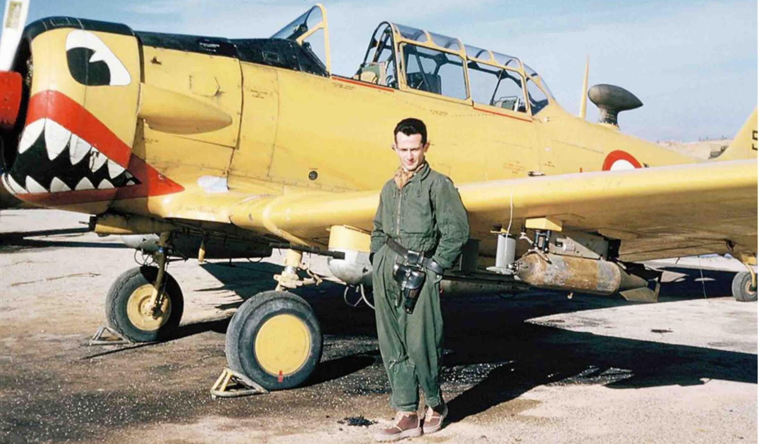
Bidon de napalm sous l'aile d'un T-6 de l'EALA 15/72
