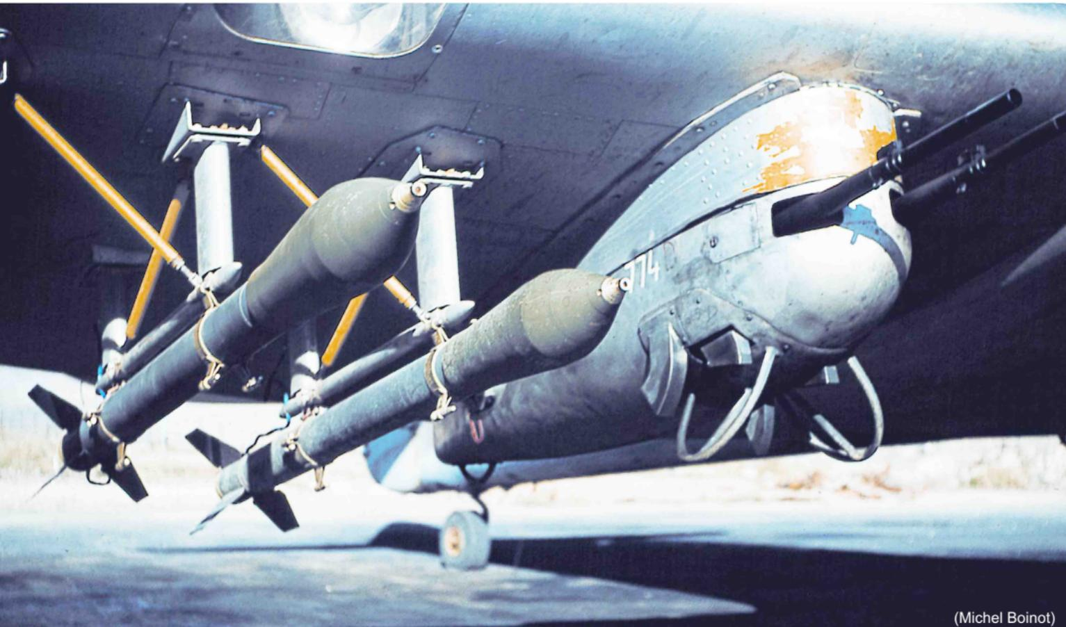
Montage d'un conteneur SAMM S.410 pour mitrailleuses MAC 52 et roquettes SNEB dans un Lance-roquettes MATRA 122
